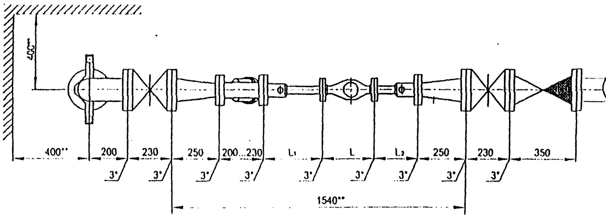
Установка счетчиков  $d_u=20...50$  мм в подомрном узле на вводе диаметром 100 мм.
